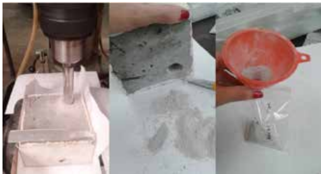
FIGURA 10 - PROCESSO PARA RETIRADA DO PÓ
