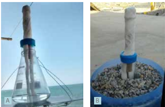
FIGURA 5 - A) VELA FIXADA COM ARAME (P25). B) VELA EM RECIPIENTE PLÁSTICO COM PEDRAS (P33)
